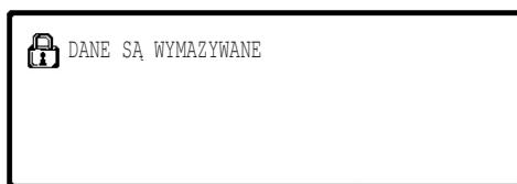
Jeśli zadanie jest duże i wymazywanie danych trwa dłużej niż 6\* sekund, wyświetlany jest następujący pasek postępu:
