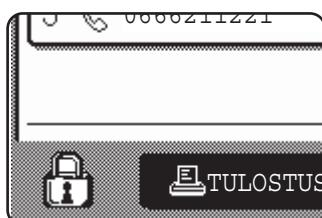
Kun tietoturvan ylläpitotyökalut on asennettu, seuraava kuvake ilmestyy kosketuspaneeliin. Kosketa kuvaketta (), työntilanäytössä nähdäksesi tietoa tietoturvan ylläpitotyökaluversiosta.
